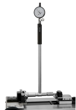
Voreinstellen von Innenfeinmessgeräten Pre-setting of bore gauge
