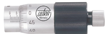
Ableseung 0,005mm, Spindelsteigung 0,5mm (100 Teilstriche auf der Trommel)
