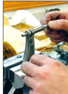
Einbau einer neuen Mikrometerspindel Mounting of a new micrometer spindle
