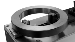
Messung von Innendurchmessern Measurement of inside diameters
