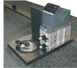
Prüfvorrichtung mit Hartgesteinbasis zur Kontrolle der Geradheit von Druckmaschinenwellen, schonende Vorzentrierung in Kunststoffprismen. Das Heben und Senken des Werkstücks in die Messposition erfolgt pneumatisch.
