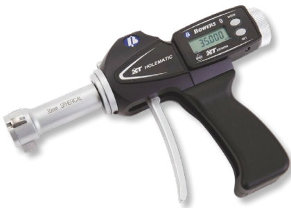
Digital-Innen-Schnellmessgerät mit balligen Messflächen für eine gute Wiederholgenau- igkeit auch ohne Übereinstimmung der Bohrungsmitte. Lieferbar für Ø 6-300mm.
