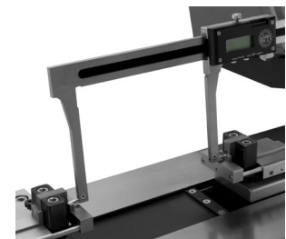
Voreinstellen von Universalmessschiebern Pre-setting of universal calipers
