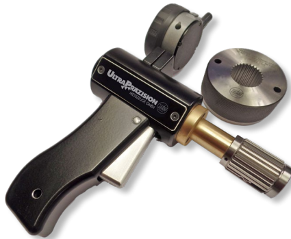
Kombo-Verzahnungslehrrdorne mit Messuhr (analog oder digital) zum Prüfen der effektiven und tatsächlichen Zahnlückenbreite an Werkstücken mit Innenverzahnung. Combo spline plug gauges with dial gauge (analogue or digital) for checking effective and actual circular space width on internal splined work pieces.
