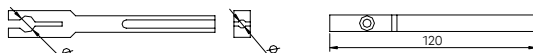
Messuhrhalter Aufnahme Ø 4mm und 8mm Dial gauge holder mounting hole Ø 4mm and 8mm
