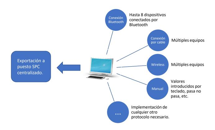
Con el software TEC-Control-SPC, podemos ir un paso más allá. Tendríamos la posibilidad de, en un puesto de trabajo, conectar los 8 equipos Bluetooth además de conectar equipos inalámbricos, equipos conectados por cable, así como módulos BPX con palpadores inductivos.
