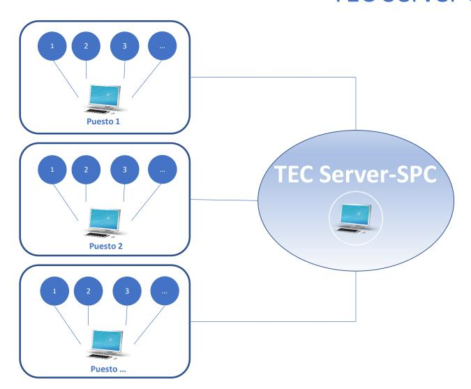
El software TEC Server-SPC nos permite controlar los procesos de verificación en los diferentes puestos individuales. De esta forma saber lo que está sucediendo en cada puesto de control en tiempo real.
